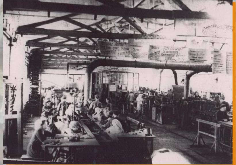
РУЧНОЙ РАСКРОЙ САПОГ, КОЖЕВЕННЫЙ ЗАВОД
